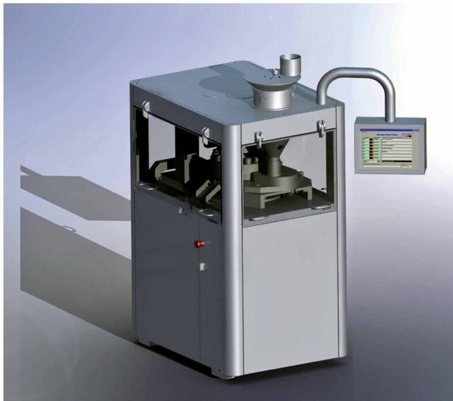
nata emblematicamente muletto in quanto in grado di comprimere pressoché tutto) e che va da 15 fino a 32 stazioni, con la possibilità di impiegare punzoni tipo Ronchi o Euronorma di tipo sia B che D.
