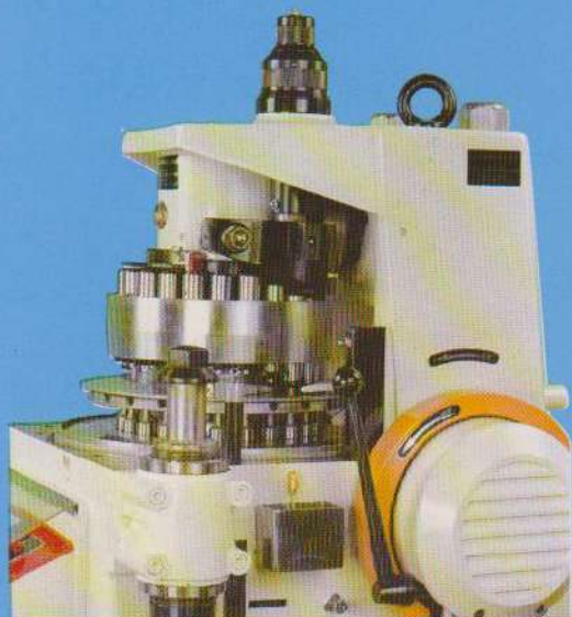
Dispositivo di precompressione a rulli regolabili indispensabile nella compressione diretta da polveri
